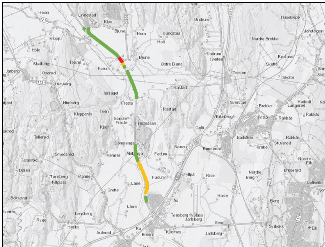
Figur 61: Oversiktskart med geotekniske tiltak. Grønt= ingen spesielle geotekniske tiltak. Gult= lettfylling dersom terrenget heves mer enn 0,5 meter. Rødt= kompensert fundamentering. Nord er opp på kartet. (Kilde: V-not-101 /8/)
